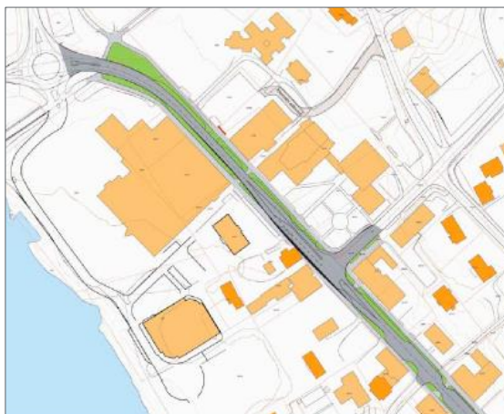
Figur 36 Utsnitt fra Rambøll sin trafikkutredning som viser venstresvingefelt i kryss Storvegen og Korsbergsvegen.
