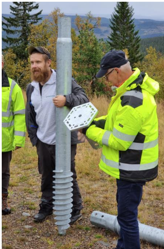
Figur 86 - Bilde som viser eksempel på punktfundament som bebyggelsen kan stå på. Punktfundamentene kan lett skrus ned/opp av bakken
